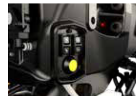
Externa reglage finns på traktorns front och bakre del för trepunktslyften, kraftuttaget och en extra styrenhet.
