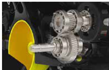
Direkt kraftöverföring från motorn till det främre kraftuttaget.
