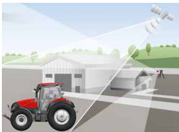
xFill överbryggar förlust av RTK+-signalen i upp till 20 minuter
