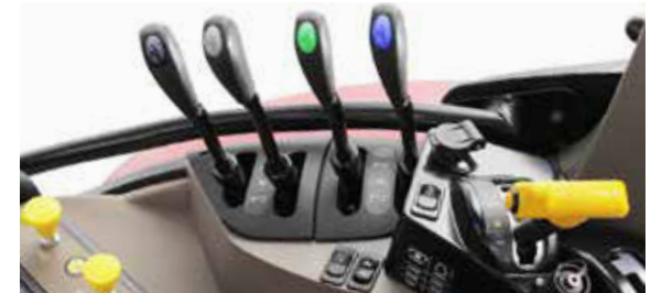
Modeller med endast mekaniska bakre hydrauluttag tillåter även styrning via ergonomiska manöverspakar.
