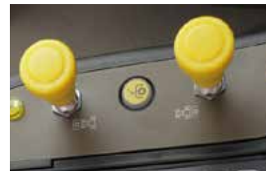
Elhydraulisk aktivering av det bakre och främre kraftuttaget.
