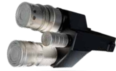
Hydraulmotorer eller redskap som ställer höga krav på hydraulsystemet kan matas med upp till 110 l olja per minut via Power Beyond-anslutningen.
