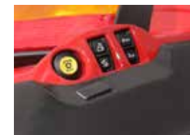
Externa reglage finns på traktorns front och bakre del för trepunktslyften, kraftuttaget och en extra styrenhet.
