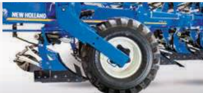
Sidomonterat kombihjul – 11.5/80-15.3 Sidomonterat kombihjul – 11.5/80-15.3 Hydr. djupreglering
