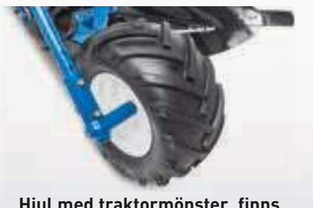
Hjul med traktormönster, finns även med hydr. djupreglering – 26x12.00-12
