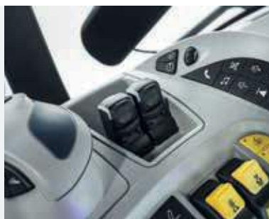
Reglage till hydrauluttag med två spakar (tillval)
