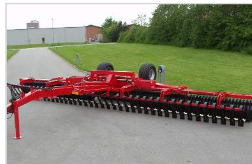
10,20 m m/620 mm/24", m/Spring-Board och Tvärlåssystem
