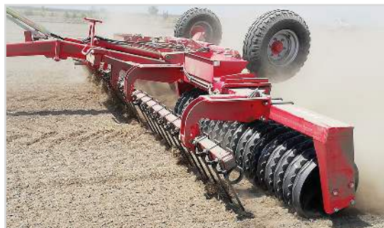
6,30 m Tip-Roller med Cambridgeringe och Spring-Board med Ø16 mm langfingertænder
